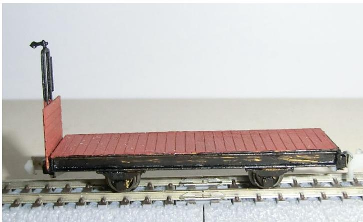
Variante von Gattung 776 → Flachwagen mit einer Stirnwand und Heberleinbremse
